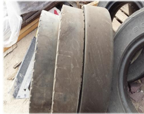
<Desgaste rápido y rotura de llanta>
