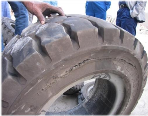
<Rotura de caja o talón>
